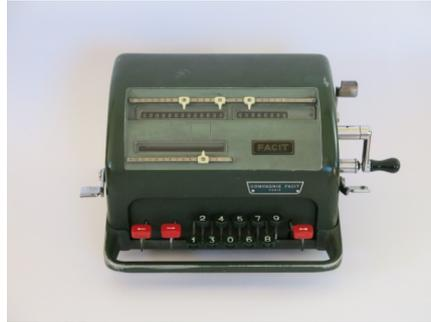
machine de Odhner avec clavier (1932)
