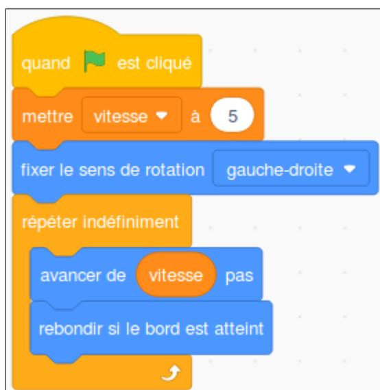
Lorsque l'animation débute, la vitesse est paramétrée à 5, le sens de rotation du fantôme à « position à gauche ou à droite ». Le fantôme avance en permanence et rebondit si le bord est atteint, repartant ainsi dans l'autre sens.
